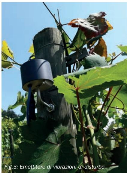
Fig.3: Emittitore di vibrazioni di disturbo
