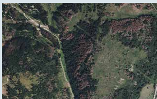
Mappatura delle infestazioni di bostrico ottenuta tramite l’analisi automatica di immagini satellitari.
